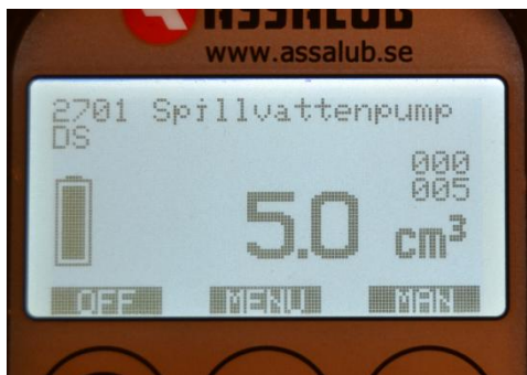
Figur 33, Fettmätaren ansluten till en smörjpunkt
