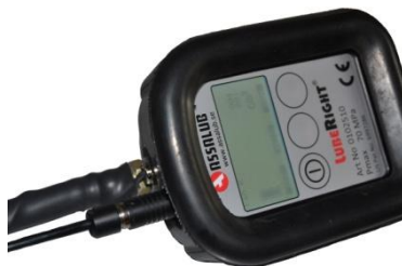
Figur 26, Anslutningen av USB-kabeln i fettmätaren
