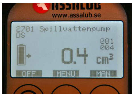
Figur 34, Smörjpunkten "2701 Spillvattenpump DS" har översmörjts med 0,4 cm 3
