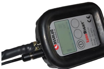
Figur 13, USB-kabelns anslutning på fettmätaren
