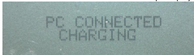
Figur 17, "PC CONNECTED" visas när fettmätaren är påslagen och ansluten till en dator
