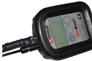
Figur 29, Anslutningen av USB-kabeln i fettmätaren
