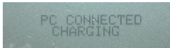
Figur 30, "PC CONNECTED" visas i displayen när fettmätaren är ansluten till datorn
