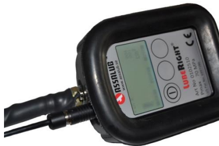
Figur 16, USB-kabelns anslutning på fettmätaren
