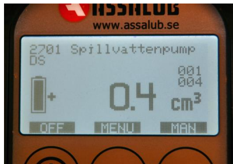
Figur 37, Smörjpunkten "2701 Spillvattenpump DS" har översmörjts med 0,4 cm³
